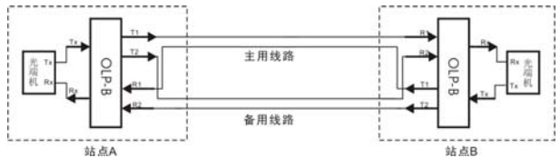
图 4 OLP-B 型光线路保护器应用于干线保护
